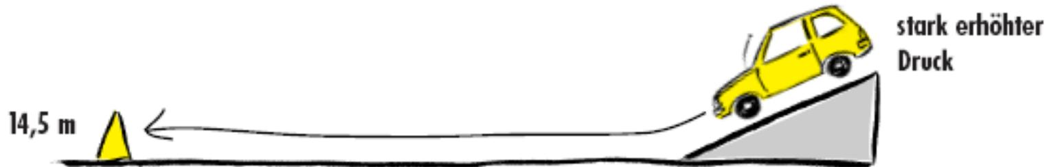
Rollweite mit Normaldruck: 13,0 m; mit stark erhöhtem Reifendruck: 14,5 m.
